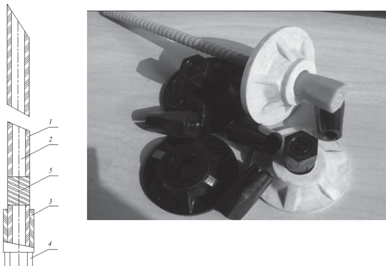
1 – стержень АНК-С трубчатого сечения; 2 – внутренний канал; 3 – втулка; 4 – торец нижний граненый; 5 – опорная пластина
