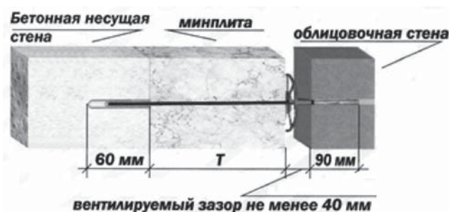
Рисунок Е.3 – Схема установки гибких связей для утепления и облицовки монолитной стены
